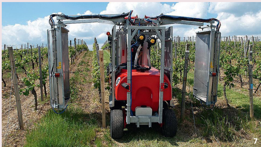
Irroratrice dotata di sistema di riciclo per una perdita minima di prodotti fitosanitari
